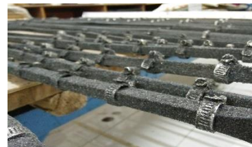
Gambar 4. Hasil pemberian lapisan pada tulangan bambu.
